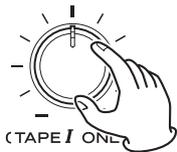
Ruotando in senso orario la manopola PITCH CONTROL (verso +) si aumenta la velocità di riproduzione e si alza l'intonazione (il massimo è il 12%, che è circa due semitoni più alta).
