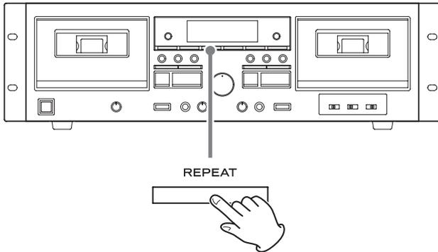
Im Display wird *RE 1* eingeblendet.
