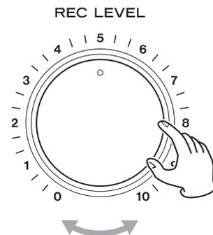
Geben Sie die Quelle wieder und speisen Sie ein Signal über das Mikrofon ein. Nun stellen Sie den Regler REC LEVEL (Aufnahmepegel) so ein, dass die Peak-Pegelanzeige den Wert 0 nicht dauerhaft überschreitet.
