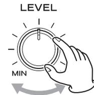
Während Sie eine Signalquelle mit dem Mikrofon abnehmen, drehen Sie den Regler MIC LEVEL auf und stellen so das Verhältnis zwischen der Quelle und dem Mikrofonsignal ein.
