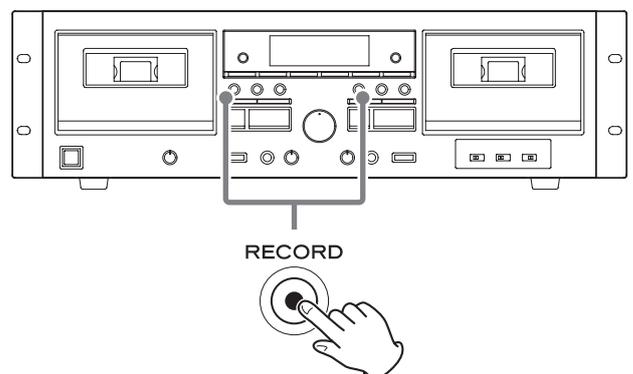
Im Display werden die Symbole **II** und **REC** eingeblendet.
