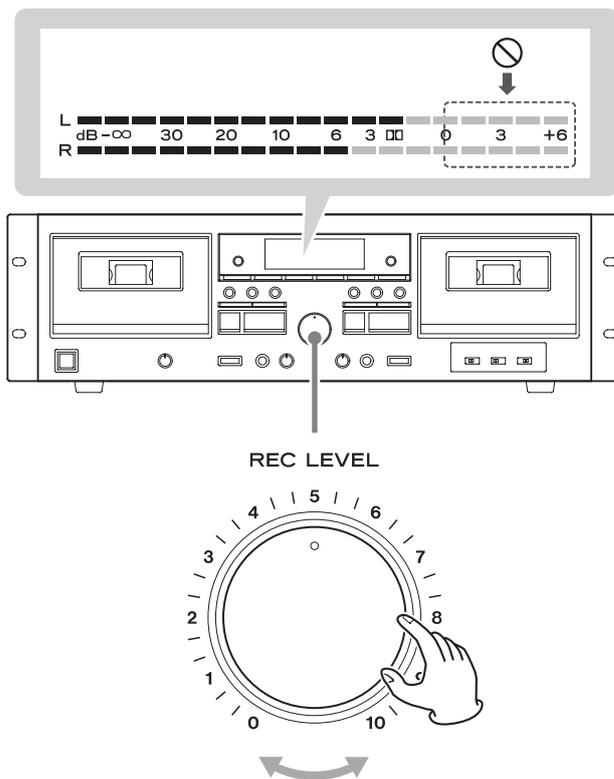
Riprodurre la sorgente e, mentre si immette il suono dal microfono, regolare la manopola REC LEVEL (livello di registrazione), in modo che l'indicatore del livello di picco non superi mai lo 0.
