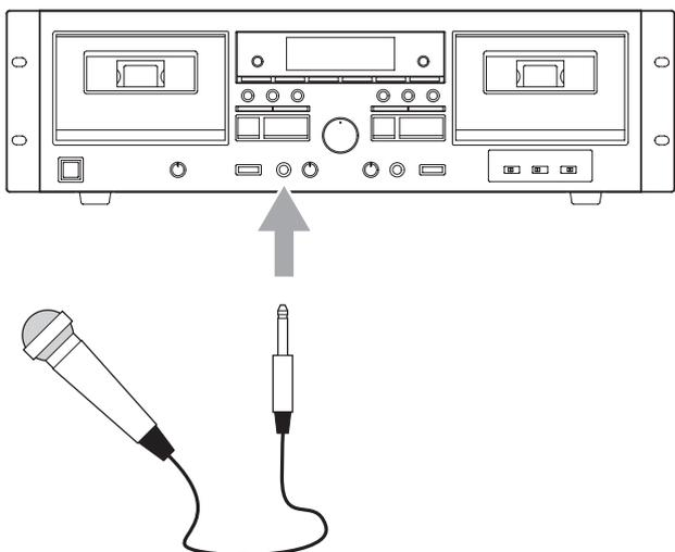
Collegare il microfono al connettore MIC sulla parte anteriore dell'unità.
