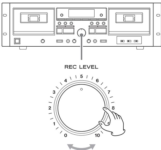
Riprodurre la sorgente e regolare la manopola REC LEVEL (livello di registrazione), in modo che il livello sia leggermente più basso.
