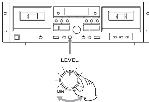
Durante l'immissione di suoni con il microfono, ruotare la manopola LEVEL del microfono per regolare il bilanciamento tra i suoni della sorgente e il microfono.
