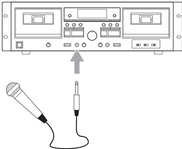
Collegare il microfono al connettore MIC sulla parte anteriore dell'unità e seguire le procedure di registrazione (pagina 48) per registrare. Quando si regola il livello di registrazione al passaggio 3 delle procedure di registrazione, regolare i livelli della sorgente e del microfono come segue.
