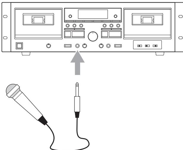
Schließen Sie das Mikrophon an der Buchse MIC auf der Vorderseite des Geräts an.
