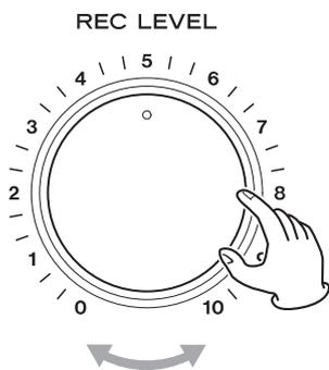
Geben Sie die Quelle wieder und passen Sie den Regler REC LEVEL (Aufnahmepegel) so an, dass die Quelle relativ niedrig angesteuert ist.
