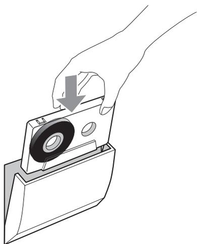
Inserire la cassetta con il lato di riproduzione rivolto in avanti e il lato aperto rivolto verso il basso. Quindi, chiudere il vano cassette con una leggera pressione. Usare cautela, perché forzare la chiusura potrebbe causare malfunzionamenti.
