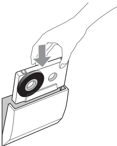
Legen Sie die Kassette so in das Fach ein, dass die Wiedergabe-seite nach vorne und die Öffnung an der Kassette nach unten zeigt. Schließen Sie das Kassettenfach anschließend mit sanftem Druck. Seien Sie vorsichtig, da es bei zu großem Druck zu Fehlfunktionen kommen kann.
