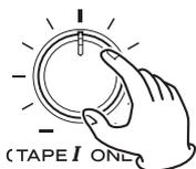
Drehen Sie den Regler PITCH CONTROL im Uhrzeigersinn (in Richtung +), um die Wiedergabegeschwindigkeit und damit die Tonhöhe anzuheben. (Der Maximalwert 12% entspricht einer Transponierung um etwa zwei Halbtöne nach oben.)
